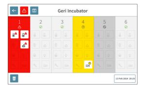
Tippen Sie während eines aktiven Alarms bzw. einer aktiven Warnung auf das Alarmsymbol . Der aktive Alarm bzw. die aktive Warnung wird hervorgehoben, während die zugehörige Kammer in rot (Alarm) bzw. gelb (Warnung) markiert wird. Der Alarm bzw. die Warnung selbst werden ebenfalls hervorgehoben.
