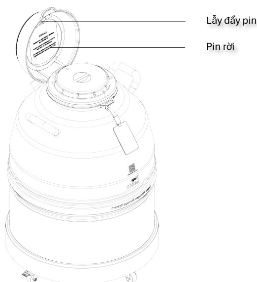
Hình 2-11 Các điểm tiếp xúc tháo và đẩy pin
