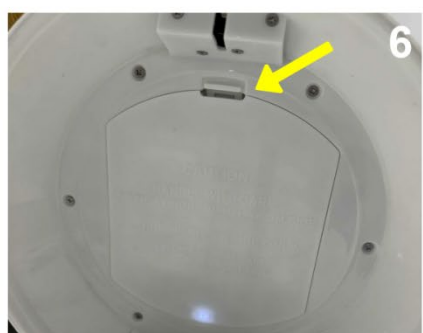
Hình 2-12: Thay pin – Tháo pin (3 hình bên trái) và Lắp pin (3 hình bên phải)
