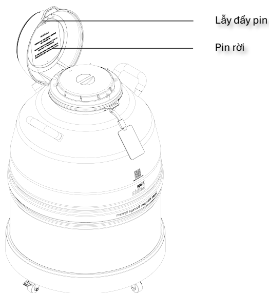
Hình 2-11 Các điểm tiếp xúc tháo và lắp pin
