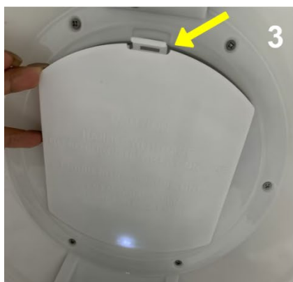
Hình 2-12: Thay pin – Tháo pin (3 hình bên trái) và Lắp pin (3 hình bên phải)
