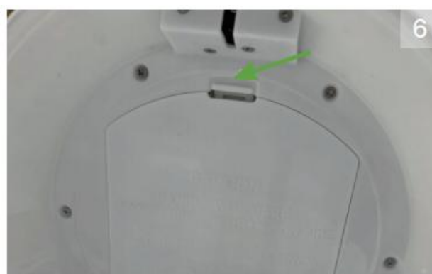
Figura 2-12 Sustitución de la Batería: Expulsión (las 3 figuras de la izquierda) e Inserción (las 3 figuras de la derecha)
